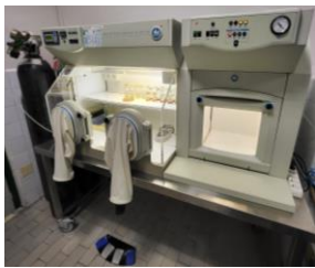
Estación de trabajo e incubación en atmósfera controlada
