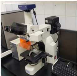
Microscopio de contraste de fases y epifluorescencia con análisis de imagen
